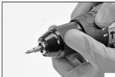
Postavljanje bita u steznu glavu
